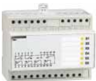
Contactos M6C: relés externos al interruptor con 6 contactos inversores independientes pilotados desde el interruptor por una conexión de 3 hilos
